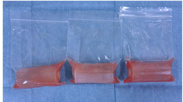
図. 鋳型空隙部に各種足場を充填し脱気して凝固させた埋込サンプル
